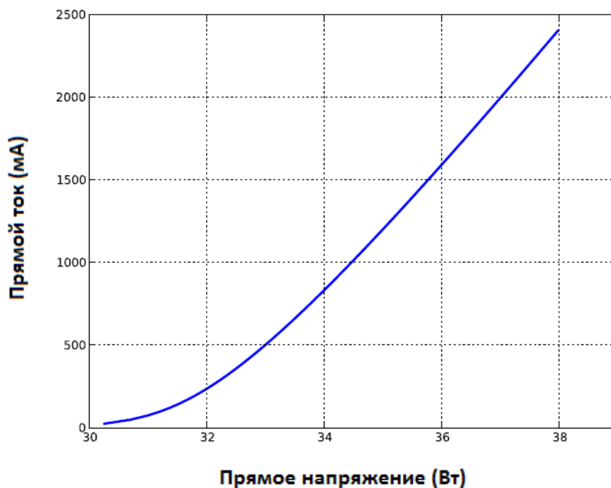
Рисунок 6. Номинальный входной ток зависимости от прямого напряжения для L2C5-xx001211E1900 при T_j=85^\circ\text{C} .
